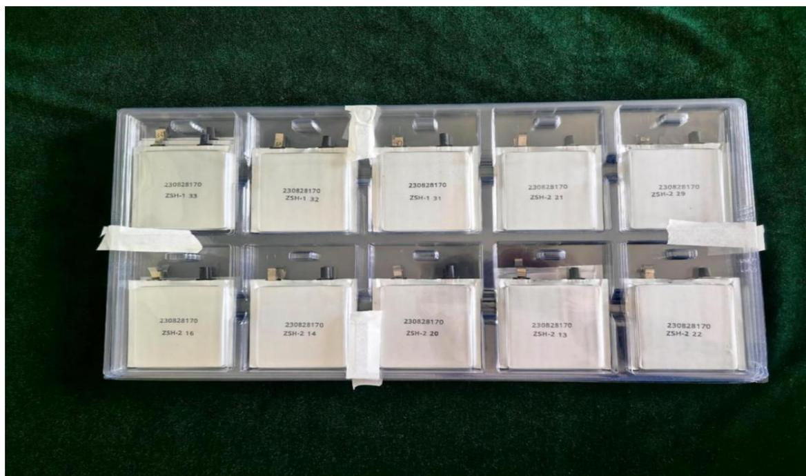
**电池软包铝塑膜**，简称铝塑膜，是一种用于封装锂离子电池的复合软包装外壳材料，常用于软包电池和刀片电池中。软包锂离子电池专用封装材料，起到保护内部电芯、隔绝外界环境的作用。相较钢壳、铝壳等电池壳体材料，软包铝塑膜有着**重量轻、比能量高、内阻小、安全性高**等优点。
