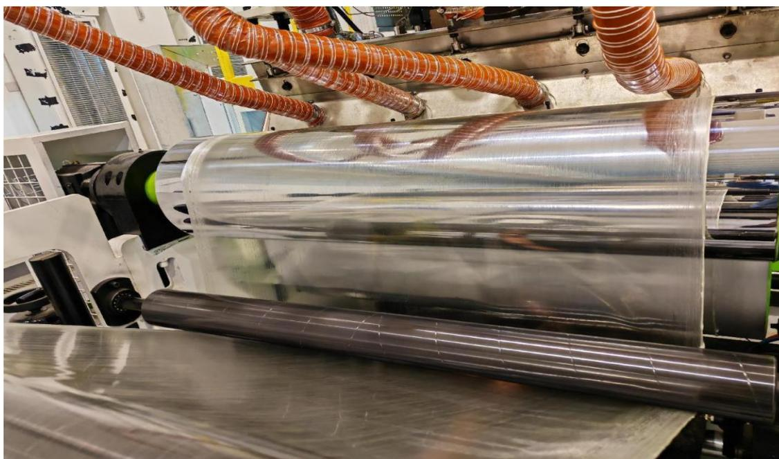
北化院从2017年起开始研发电池铝塑膜用CPP专用料和薄膜生产技术。通过数年实验探究了影响软包膜**耐冲深**、**热封**和**耐电解液**性能的关键，并通过**分子结构**设计和**结构调控**技术研究，开发出锂电池软包CPP系列专用料牌号，实现了工业化生产。
