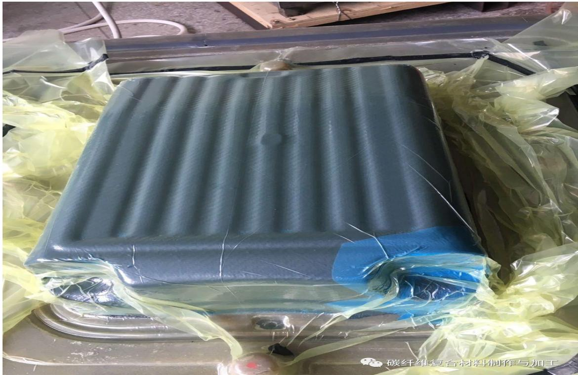
图 2 手糊法制备碳纤维/环氧树脂复合材料壳体结构
